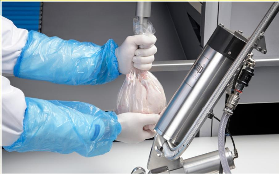
Vertikale Vakuumdüse (Zugdüse) im Einsatz mit der Clipmaschine EZ 600 der Easy Clip Line®
