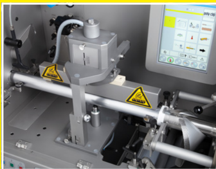
La estación de sellado térmico de la TSCA 65 D
