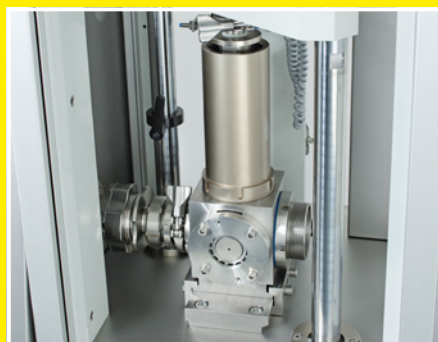
Dosificación volumétrica de la HDP - alta precisión en el llenado
