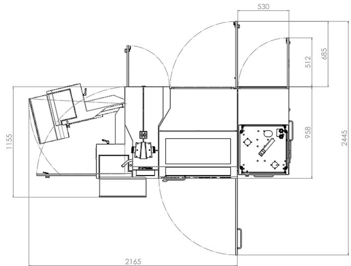
Vorderansicht (Abmessungen in mm)
