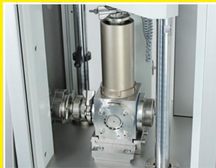
Volumetrische Dosierung der HDP – hohe Füllmengen Genauigkeit
