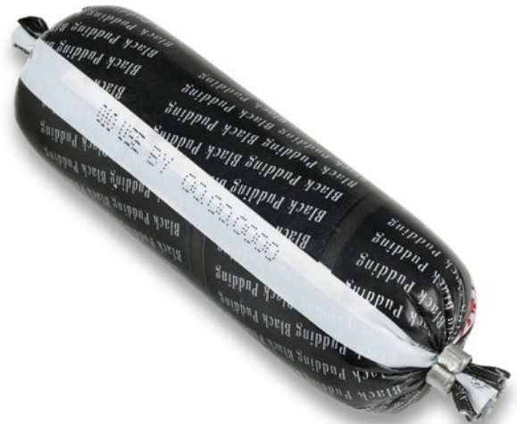
Produktkennzeichnung durch direkten Druck auf die Folie
