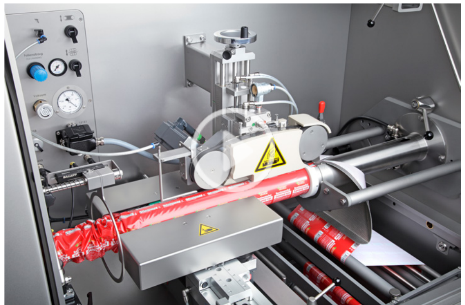
Heißsiegelstation des TSCA für zuverlässige Siegelung
