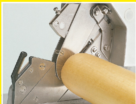
Устройство с обрезным ножом удаляет лишнюю часть кончика оболочки или пакета
