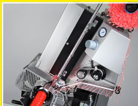
El dispositivo automático de cordel GSE está montado en la parte derecho de la máquina.
