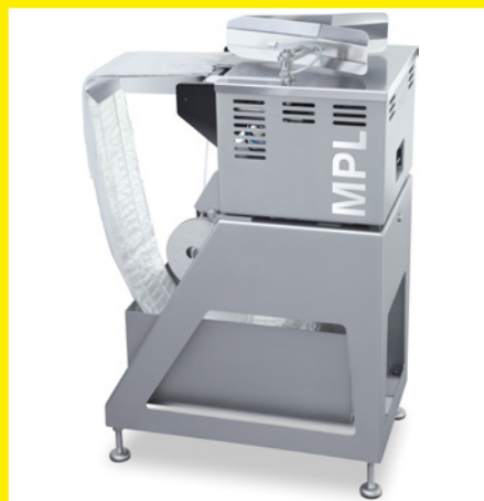
MPL с пневматической подачей термоусадочных пакетов для еще более эффективного производства
