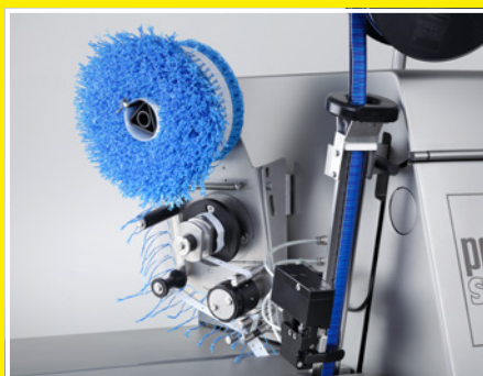
Диафрагменный фаршевытеснитель обеспечивает чистые кончики колбас и порционирование, не повреждающее оболочки.
