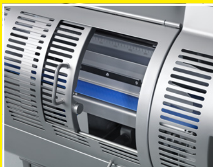
Устройство дополнительной разводки обеспечивает неплотную набивку без доступа воздуха
