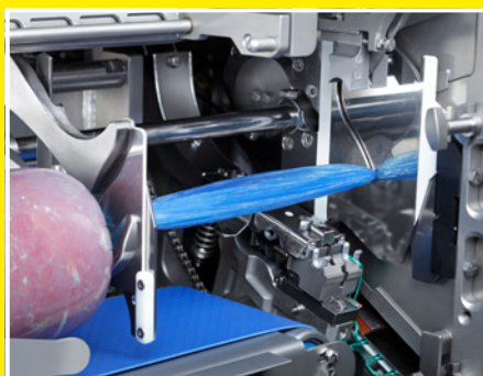
Подпрессовка для безвоздушного наполнения формованных продуктов
