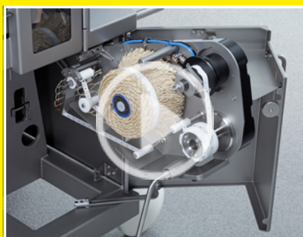
Простая смена петель благодаря откидному петлеукладчику
