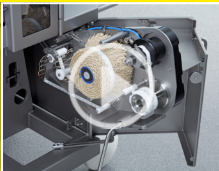
Dispositivo automático para colocar cordeles GSA retráctil para facilitar la recarga de cordeles
