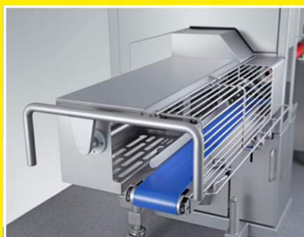
Kalibertreues Produkt durch regelbare Förderbandgeschwindigkeit
