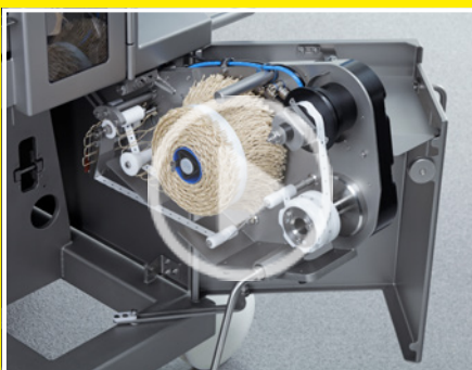
Einfacher Schlaufenwechsel durch ausschwenkbaren GSA
