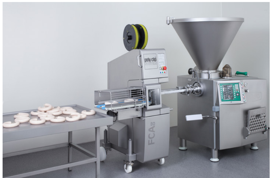
FCA 80 con tapa frontal y doble cinta de salida para sartas
