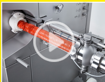
Freno de tripa con protección de seguridad
