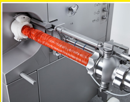
Freno de tripa con protección de seguridad
