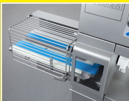
Produktauslauf mit regelbarem, doppeltem Förderband
