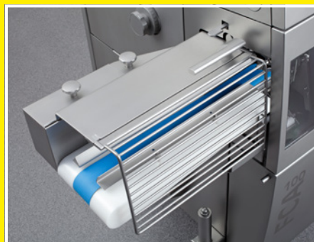
Гигиеничный дизайн транспортера, снимается без инструментов
