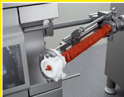
Ассистент тормоза оболочки – полуавтоматический держатель тормоза оболочки
