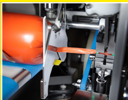
Подпрессовка для безвоздушного наполнения формованных продуктов
