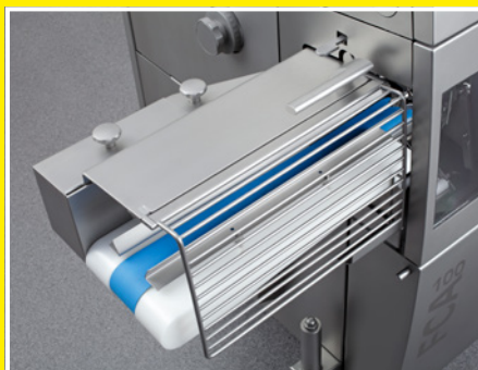
Гигиеничный дизайн транспортера, снимается без инструментов
