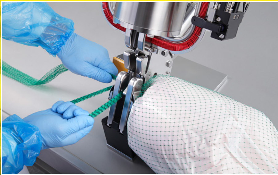
Auslöser links montiert, zur Bildung einer Schlaufe vor der Befüllung des Netzes
