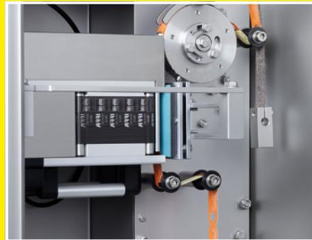
La etiqueta es insertada automáticamente y sujeta firmemente con la grapa en el producto.
